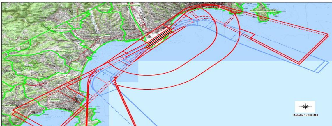
L'espace aérien environnant un aérodrome doit être protégé vis-à-vis des obstacles afin de permettre aux aéronefs amenés à l'utiliser, d'évoluer avec la sécurité nécessaire. Les procédures aériennes, imposées aux usagers aériens de la plateforme, prennent en compte de nombreux paramètres, parmi lesquels l'environnement physique aux abords de l'aérodrome.
