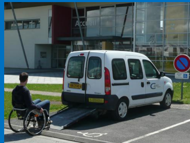
5) Caractéristiques des places de stationnement adaptées recommandées favorisant notamment l'installation d'une rampe amovible à l'arrière du véhicule
