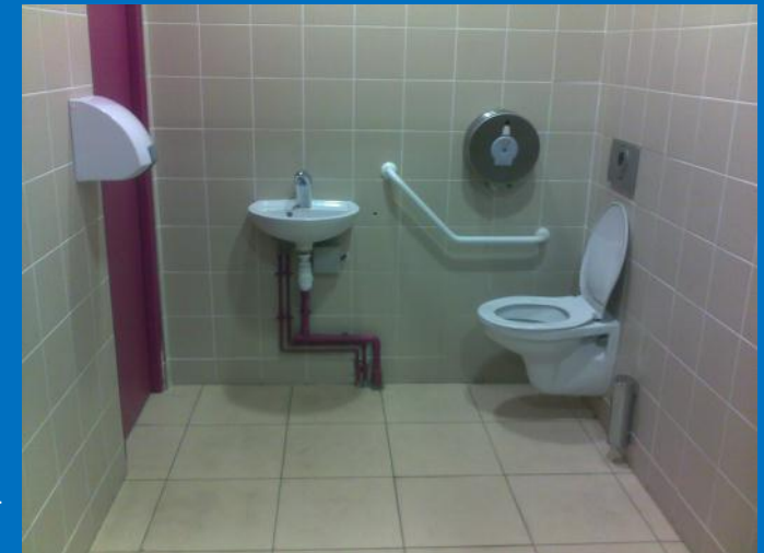
16) Illustration d'un cabinet d'aisances aménagé selon les caractéristiques réglementaires
